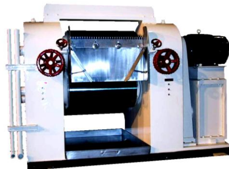
Broyeur tri cylindres ( vue de face )
