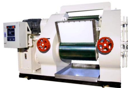
Broyeur tri cylindres ( vue de dos )
