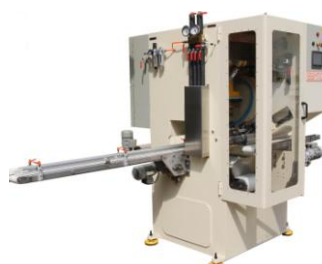
Presse-mouleuse verticale et son moule « à cracher »
